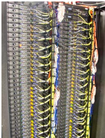
Imagen de Neptuno, que consta de 1280 cores y 5 TB de RAM
