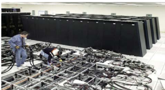
[Figura 3] Despliegue de un Toro de 3 dimensiones en un IBM BluGene\L
